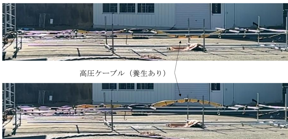
解説図 9 短絡機械力測定試験状況（ケーブルが跳ねている状況）
