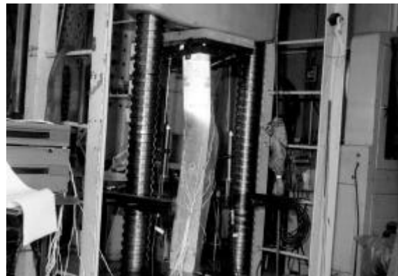
写真3 曲げねじれ座屈 (L-150x10, λ=40)
